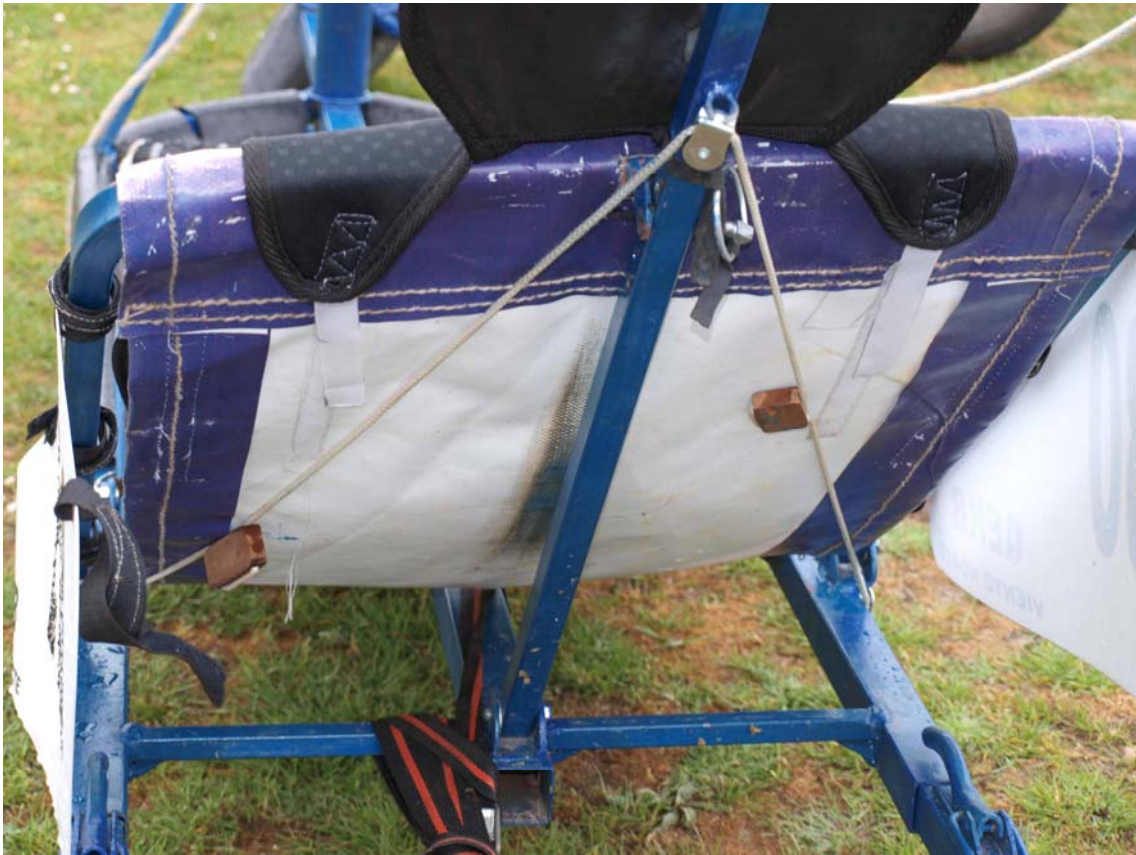
Interesante detalle trasero para facilitar el transporte y dirigir el carro desde atrás.
